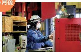
一次加工作業者として資材運搬・鋼材の切断やL穴あけ加工など基本的な作業を行います。
